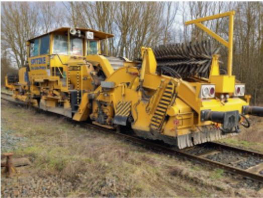
und richten lassen. Die bekannte Gleisbaufirma Spitzke hat uns hier unterstützt. Die benötigten Maschinen waren gerade in der Gegend. Einen einsatzfreien Tag haben wir ausgenutzt. Sehr beeindruckend hat die Maschine den Abschnitt gestopft und gerichtet. Das Ergebnis ist sichtbar, die Strecke sieht hier nun wieder wie neu aus. Fast wie neu. Auf jeden Fall ist das Gleis nun nachhaltig saniert. Denn in absehbarer Zeit werden an dieser Stelle keine Gleisbauarbeiten mehr notwendig sein.
